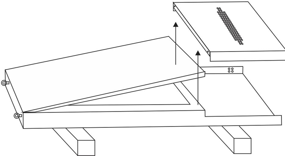
2. Fija la base de hierro en la parte inferior del display, alineándola con los rieles de guía. Asegura cada lado utilizando los 8 tornillos proporcionados.
