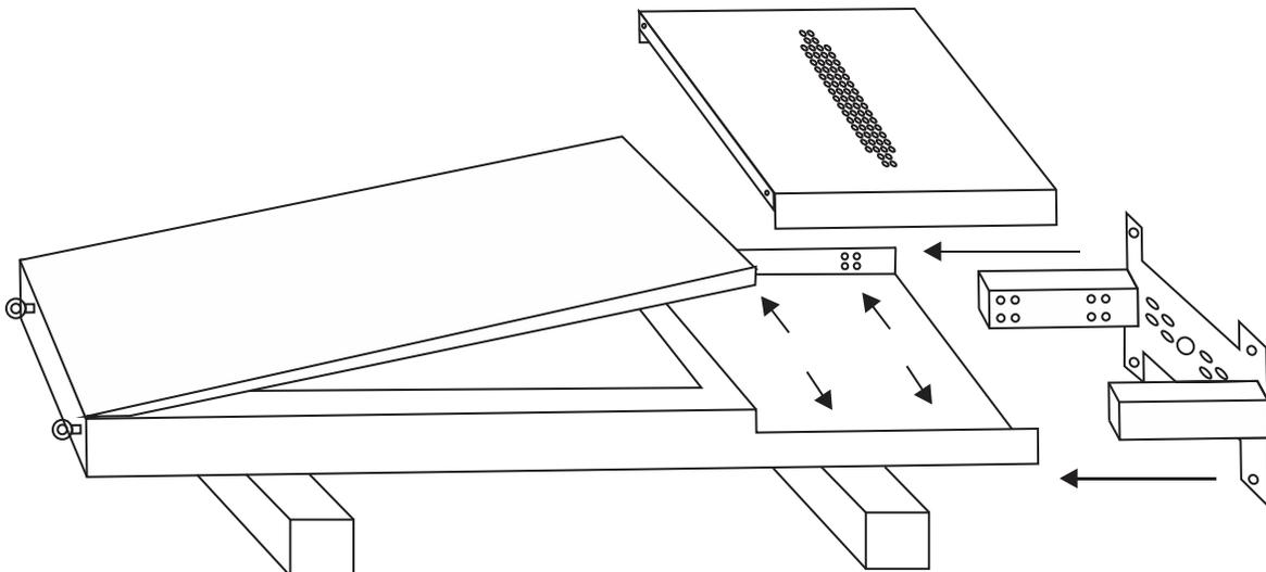
3. Con la ayuda de una grúa, levanta el display y colócalo en el lugar asignado, donde previamente se ha realizado la instalación eléctrica y de los cables de datos. El cable de energía y el cable de datos deben pasar por el agujero central de la base. Asegura el display a la base de hormigón utilizando los 12 tornillos.
