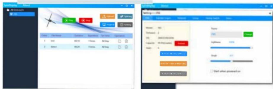
3. Klicken Sie auf „Upload“ um Bilder und Videos hinzuzufügen. Über die Option „Setup“ kann der Name des Geräts geändert, der Router angeschlossen und andere Verbindungen hergestellt werden.
