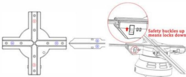
3. Nach dem Anbringen der Lichtleisten, montieren Sie die Hauptstruktur auf die Halterung. Schrauben Sie die Feststellschraube ein. Die Montage ist abgeschlossen, wie auf dem Bild unten zu sehen.
