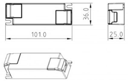
**Dimmbarer DALI Treiber DT8 CCT 220-240V - Ausgang 3-42V DC - 100-500 mA - 10W**
