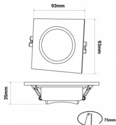
**Einbauring für GU10 - MR16 - Opal-Diffusor - Schnittgröße Ø 75-80 mm - IP54**
