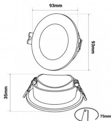
Einbauring für GU10 - MR16 - Opal-Diffusor - dicht - Ausschnitt Ø 75-80 mm - IP 54
